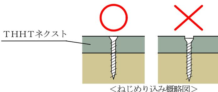
※自動ねじ打ち機で打ち込み不足が生じた場合、ドライバーなどでねじ頭がTHHTネクスト表面と面一になるように留め付けてください。
